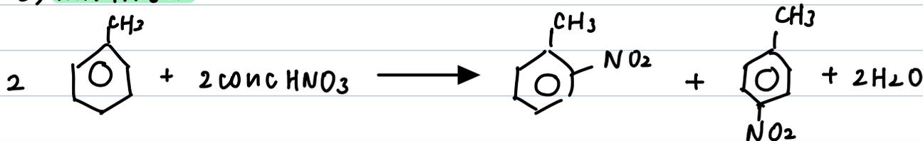
conc  $\text{HNO}_3$ , conc  $\text{H}_2\text{SO}_4$ ,  $30^\circ\text{C}$
